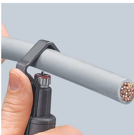
positionnement de l'outil pour coupe périphérique
