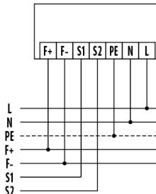
Raccordement avec contact de dysfonctionnement (S1/S2) et coupure à distance (F+/F-)
